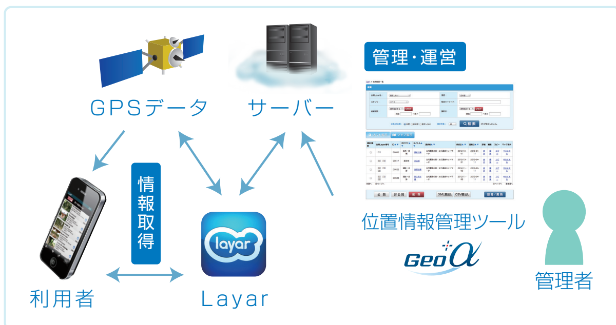
位置情報管理ツール『Geo α』サービスの仕組み
